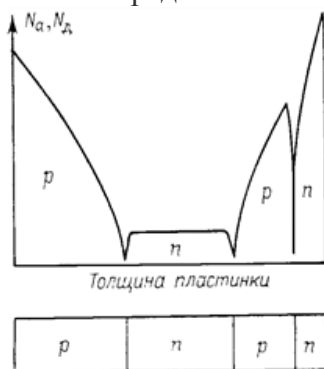
Рис. 6 - Распределение концентрации примесей при изготовлении многослойных полупроводниковых структур
