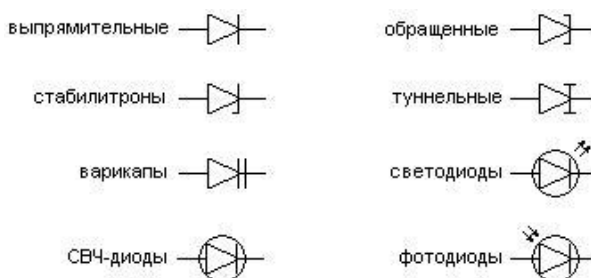
Рис. 4 Классификация и условно-графические обозначения диодов (направление стрелки на условно-графическом обозначении совпадает с направлением прямого тока)
