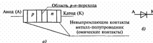
Рис. 1 Структура полупроводникового диода с электронно-дырочным переходом (а) и его условное графическое обозначение (б)
