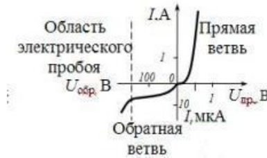
Рис. 3 Вольт-амперная характеристика (ВАХ) диода
