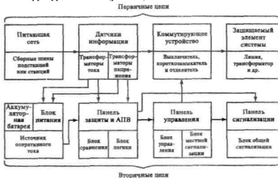
Рис. 1.1. Структурная схема устройства релейной защиты
