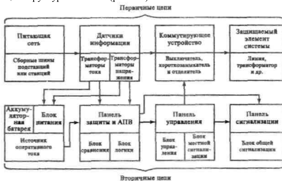
Рис. 1.1. Структурная схема устройства релейной защиты
