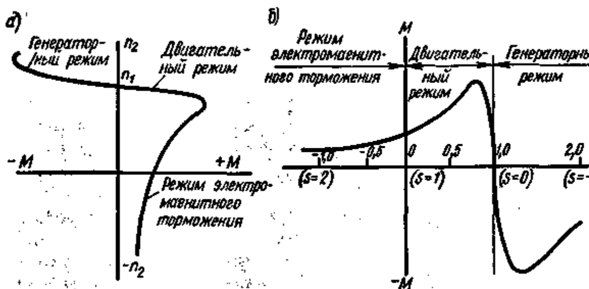
Рис. 4.21. Механическая характеристика асинхронной машины
