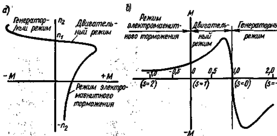
Рис. 4.21. Механическая характеристика асинхронной машины
