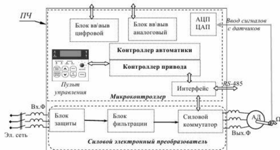
Рис. 3. Типовая структура управления асинхронным двигателем с использованием преобразователя частоты
