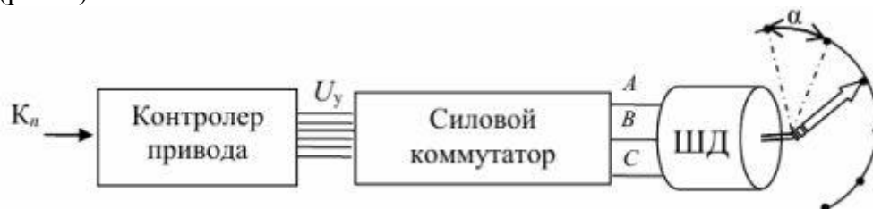
Рис. 6. Устройство управления шаговым электродвигателем
