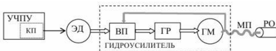
Рис. 5. Функциональная схема электрогидропривода
