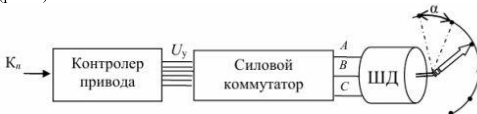
Рис. 6. Устройство управления шаговым электродвигателем
