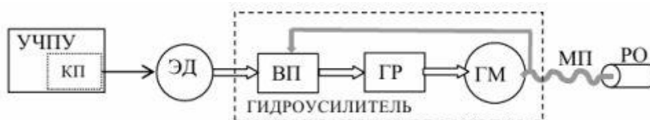
Рис. 5. Функциональная схема электрогидропривода
