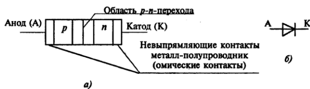
Рис. 1. Схема структуры полупроводникового диода (а) и его графическое обозначение (б)
