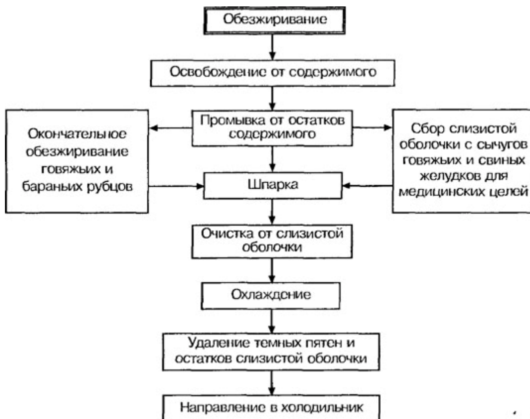
Схема 3.5. Технологический процесс обработки слизистых субпродуктов
