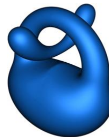
. Возможные формы гибридной орбитали, образованной за счет гибридизации s -, p -, и d -атомных орбиталей. Форма этой орбитали зависит от магнитного квантового числа, характеризующего орбиталь.
