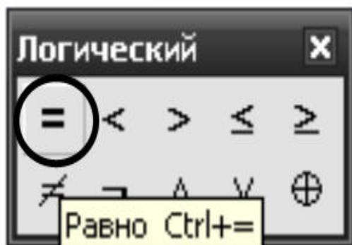
Далее приравниваем производную к нулю, чтобы найти критические точки. Вводим ключевое слово Given и производную нашей функции приравниваем к нулю с помощью логического знака равенства. Затем указываем функцию Mathcad Find(x) и знак символической оценки. Координаты полученных точек добавляем на график через запятую.
