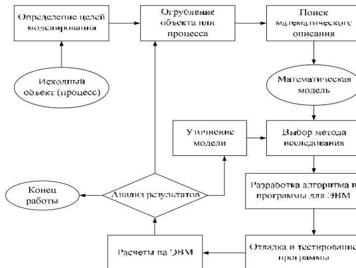
Общая схема процесса компьютерного математического моделирования
