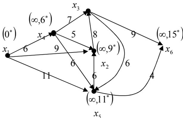
Поскольку в данном графе есть цикл между вершинами  $x_2, x_3$  и  $x_5$ , то вершины графа нельзя упорядочить по алгоритму Фалкерсона. На рисунке графа временные и постоянные метки указаны над соответствующей вершиной. Итак, распишем подробно работу алгоритма Дейкстры по шагам.
