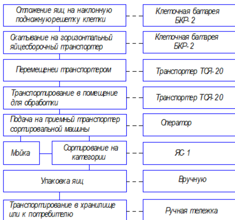
Рис. 1. Конструкторско-технологическая схема линии первичной обработки яиц
