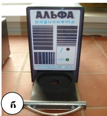
ис. 3. Альфа – радиометр (а), в открытом виде (б), с контрольным источником (в).
