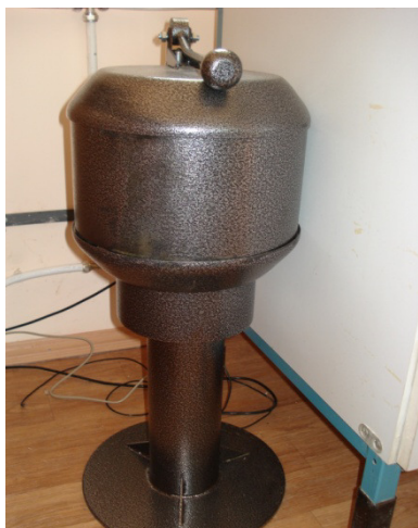
Рис. 2. Гамма - спектрометр (а), в открытом виде (б), с контрольным источником (в).
