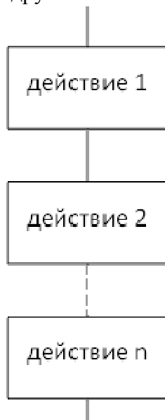
Рисунок 1- Блок-схема линейного алгоритма
