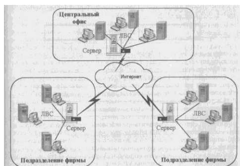
Рис. 3 – Вариант построения корпоративной сети крупного предприятия
