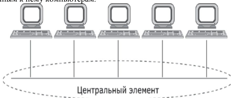
Рисунок 7 - Топология "общая шина"
