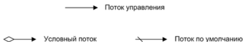
Рисунок 8 - Типы потоков управления в BPMN 1.1
