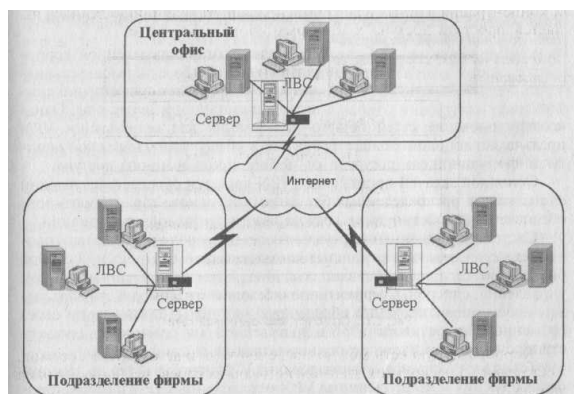
Рис. 3 – Вариант построения корпоративной сети крупного предприятия
