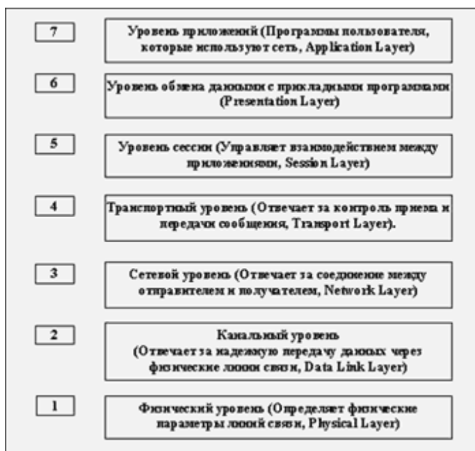
Рисунок 21. Семиуровневая модель протоколов межсетевого обмена OSI
