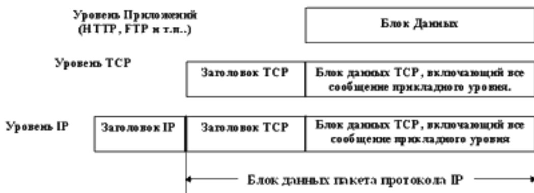
Рисунок 24. Инкапсуляция протоколов верхнего уровня в протоколы TCP/IP
