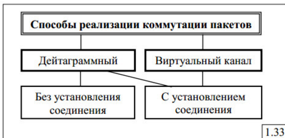
Рисунок 5. Способы реализации коммутации.
