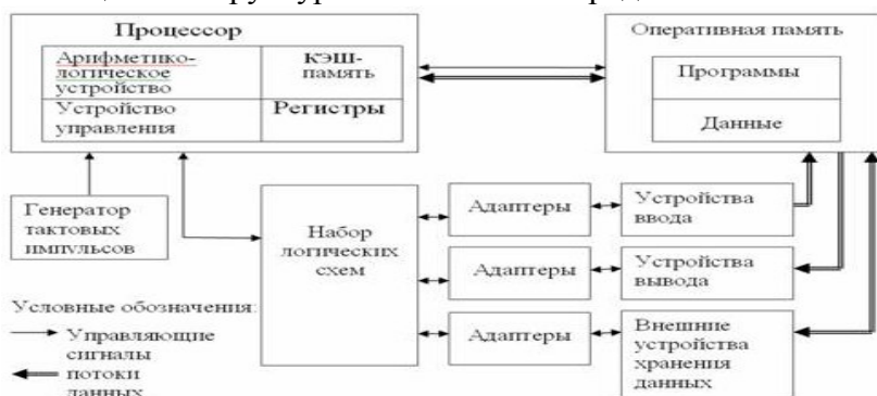
Рис. 1 Обобщенная структурная схема ЭВМ
