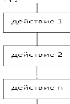
Рисунок 1- Блок-схема линейного алгоритма
