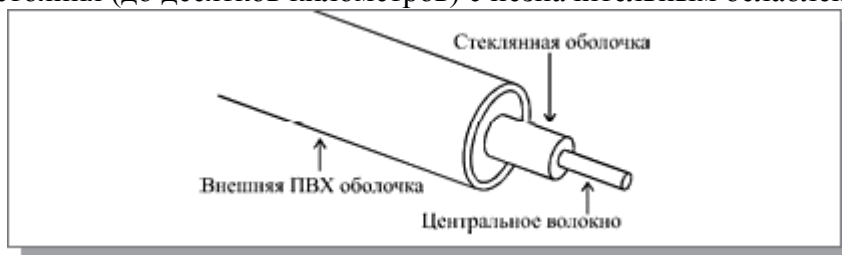
Рис. 3.3 – Структура оптоволоконного кабеля
