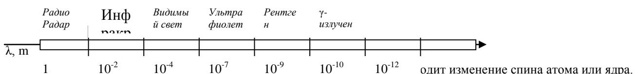
Инфракрасное – за счет колебаний атомов в молекуле. Видимое, ультрафиолетовое – за счет квантовых переходов внешних электронов атома из возбужденного состояния в основное. Рентгеновское – за счет перехода электронов с внешних оболочек на внутренние. Гамма-излучение – связано с ядерными процессами и никак не связана с электронами.
